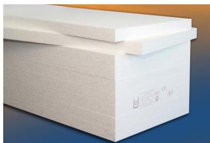
Die Universal-Dämmplatte ist eine druckbelastbare Wärmedämmplatte aus expandiertem Polystyrol (EPS-Hartschaum) mit einer Wärmeleitfähigkeit  $\lambda = 0,035 \text{ W/(mK)}$ .
