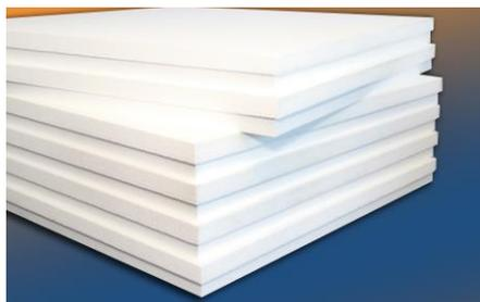
Zum Einsatz im Flachdachbereich eine druckbelastbare Wärmedämmplatte aus expandiertem Polystyrol (EPS-Hartschaum) mit einer Wärmeleitfähigkeit  $\lambda = 0,040 \text{ W/(mK)}$  und umlaufenden Stufenfalz zur Vermeidung von Wärmebrücken.
